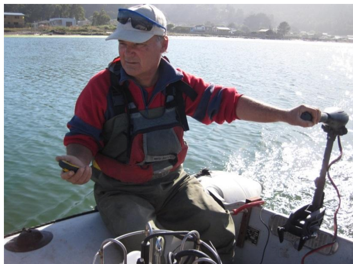
Figura 5. Imagen del recorrido en bote con motor eléctrico para la obtención de los perfiles batimétricos.
