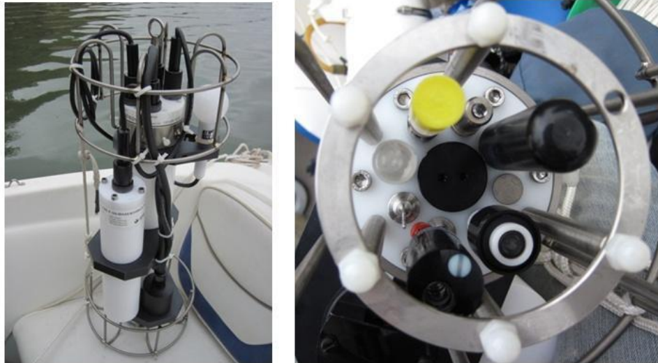
Figura 4. Sonda CTD científica Idronaut Ocean Seven 316 Plus para perfiles verticales de propiedades de la columna de agua. Tiene sensores de temperatura, presión, conductividad eléctrica, oxígeno disuelto, pH, turbidez y fluorescencia de clorofila a in-situ .
